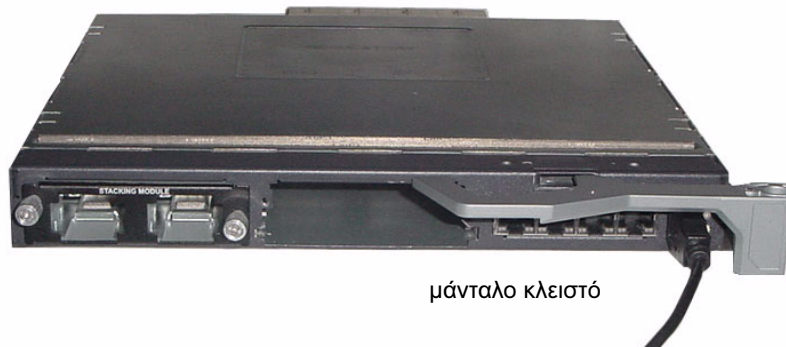
Εικόνα 1-2. Σύνδεση στη θύρα κονσόλας
