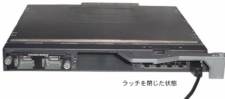
図 1-2 コンソールポートへの接続
